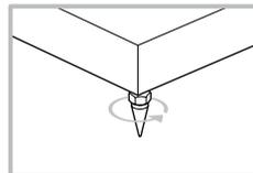
*Примечание: Установка резиновых опор почти такая же, как и шипов. Стержень и гаечный ключ входят в комплект поставки и используются только с моделью 702 S3 при установке шипов / резиновых ножек.*
